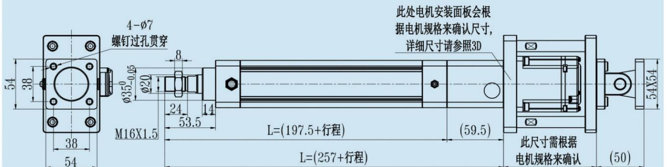
HE40电机直接安装外形图-双耳环安装-CA-CB
