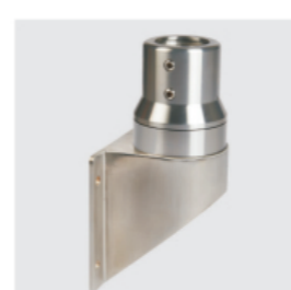
品名:垂直墙座 订货号:4870 重量:3kg 材料:不锈钢 可旋转320°
