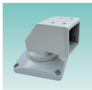
品名：顶座 订货号：80-80-DZ3 材料：铸铝 重量：8kg 可旋转 300°
