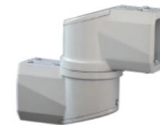
品名：中间连接件 订货号：44-60-130 重量：1.52kg 材料：压铸铝合金 可水平旋转0-320°
